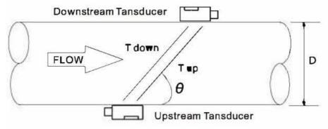
$$V = \frac{MD}{\sin 2\theta} \times \frac{?T}{T_{up} T_{down}}$$
